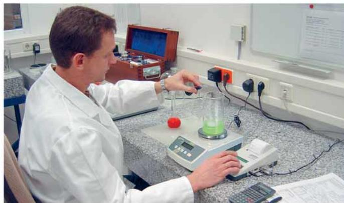
Mit der Rezepturfunktion lassen sich verschiedene Bestandteile einer Mischung zuwiegen. Zur Kontrolle kann das Gesamtgewicht aller Bestandteile aufgerufen werden. Dokumentation der Mischung mit Standard-Drucker KERN YKB-01 <sup>3</sup> möglich.
